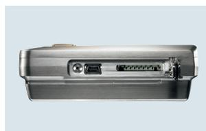
Collegamento laterale per cavo Mini USB e scheda SD
