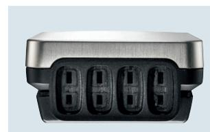
Collegamento sonda allabase dell'involucro per quattro sonde a termocoppia (Tipo T, K e J)
